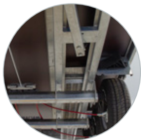
Sterk chassis met geïntegreerde rijplaathouders
